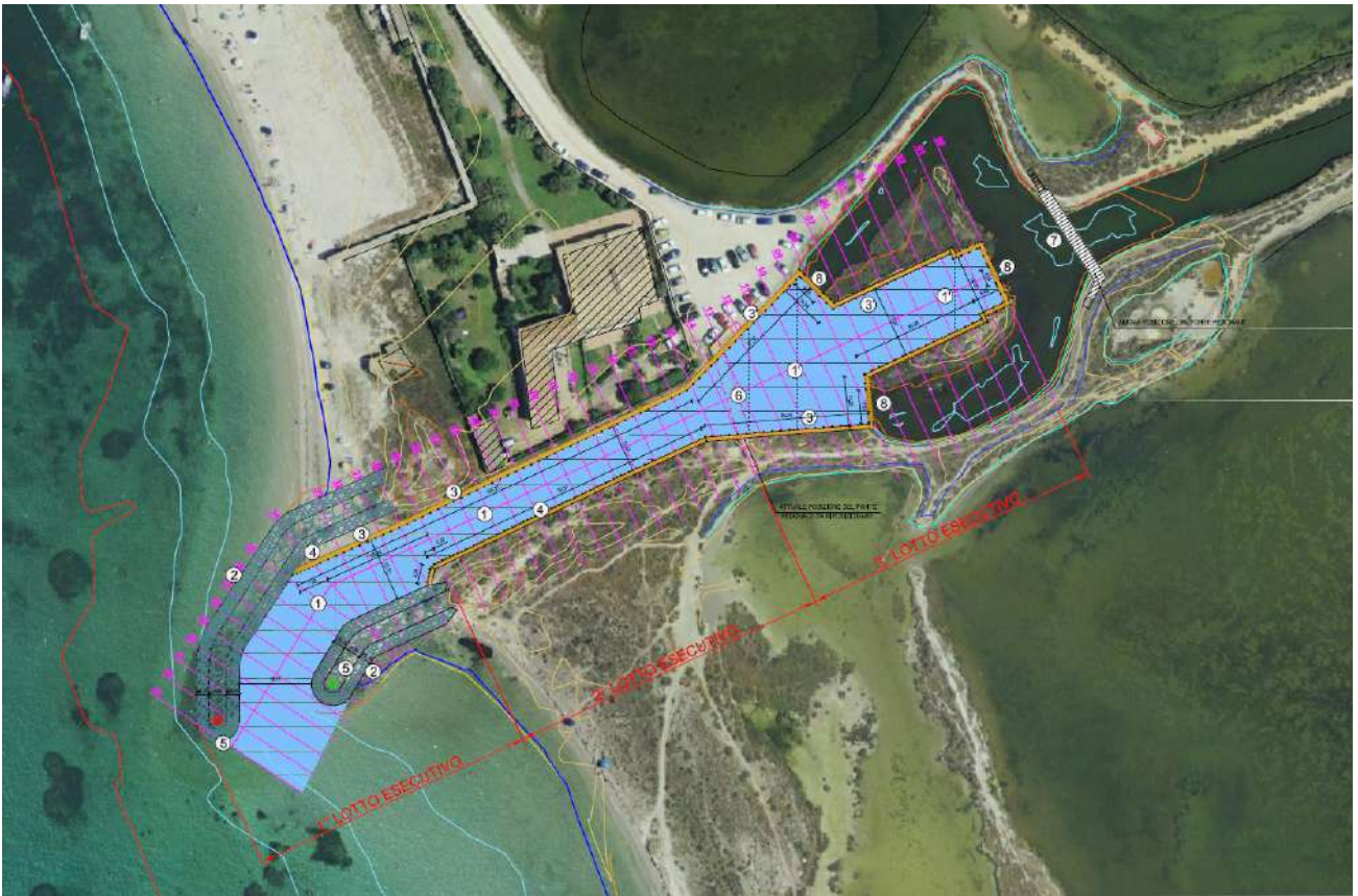
Fig. 159. Recupero e riconversione della pescheria di Porto Botte - planimetria di progetto (marzo 2014)
